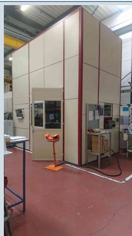
Les **panneaux acoustiques** « Zed50 » de COMETAC sont des panneaux sandwich sur mesure. Les matériaux utilisés lui confèrent un indice d'isolement et un coefficient d'absorption élevé.
